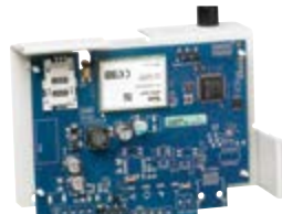
3G2080 Transmetteur GSM/3G Communication sur réseau 3G Application smartphone Télémaintenance, télégestion Cryptage données AES 128 bits Antenne fournie
