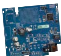
TL280 Transmetteur IP Application smartphone Télémaintenance, télégestion Cryptage données AES 128 bits
