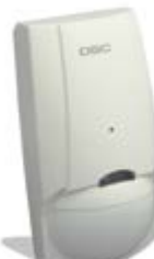
LC102 Détecteur IRP et de bris de glace Portée 12 m Immunité de 15 à 25kg
